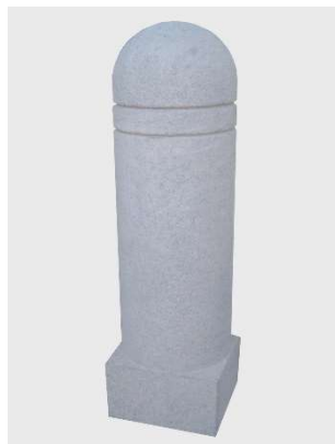
BOCCIARDATO CON TESTA SEMISFERICA, DOPPIA SCANALATURA E BASE SQUADRATA ALTEZZA TOTALE CM.100/120 DIAMETRO CM.35ALTEZZA BASE QUADRA CM.20
